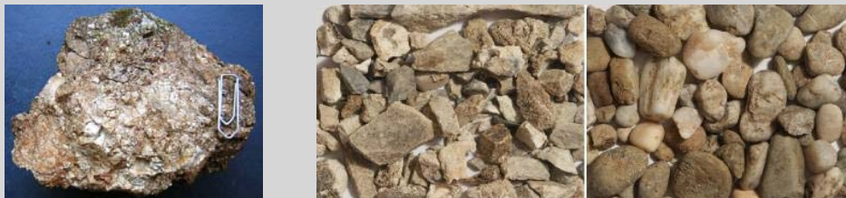
Impaktdeformation: Oben links Vergriesung eines Kalkgerölls, oben rechts stark zerbrochene Gerölle in einem Krater, demgegenüber ganz rechts normale Gerölle der Umgebung
