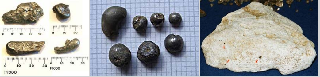
Eisensilizide finden sich als kaum korrodierte, kugel- oder tropfenförmige Partikel (oben links und Mitte) in tieferen Bodenschichten oder als kleine Splitterchen in kalkigem Gestein (oben rechts). Gewöhnlich sind die Partikel kleiner als die oben abgebildeten.
